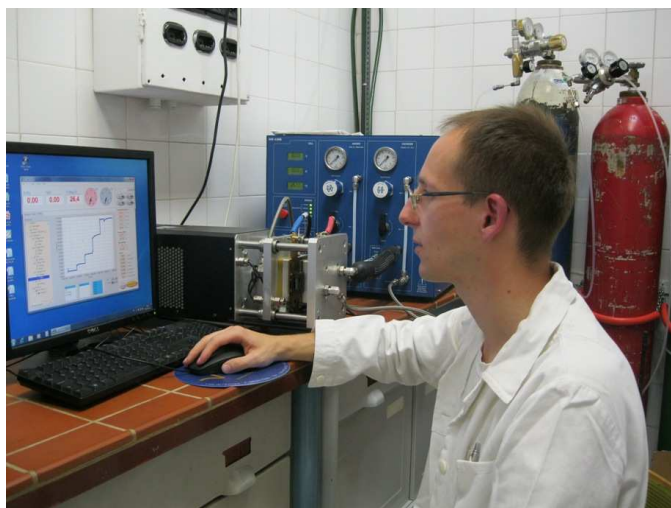
Tüzelőanyag-cellás vizsgálat az AKI-ba; középen a TC (egy ún. „stack-pres” eszközben), háttérben hidrogén palack és potenciosztat. Kép forrása: MTA TTK AKI
