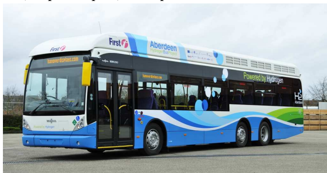
Van Hool A330 Fuel Cell Hibrid Busz, Ballard tüzelőanyagcellával: 150 kW (+Li-ion akkumulátor).
