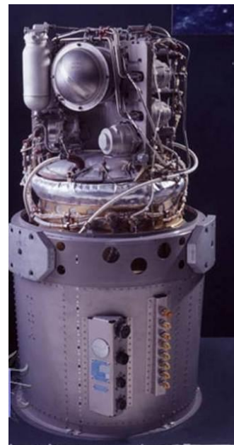
Az Apollo űrhajó (1965) alkalikus tüzelőanyag-cellája
