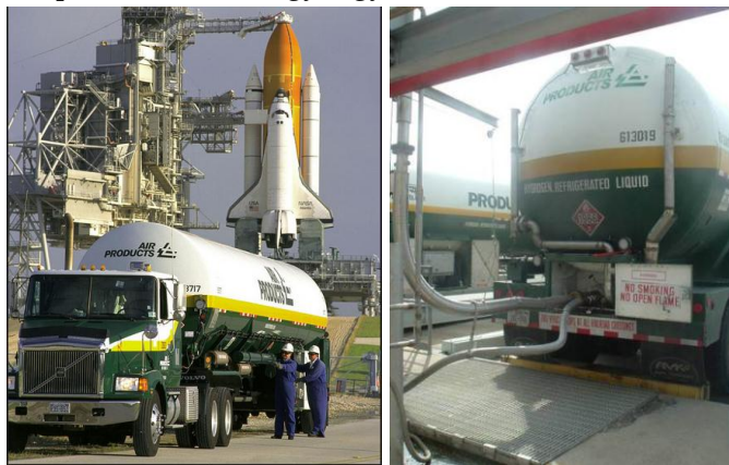
Folyékony hidrogén tréler (kb. 50 ilyen tréler szükséges egy űrmisszió hidrogénmennyiségének beszállítására)
