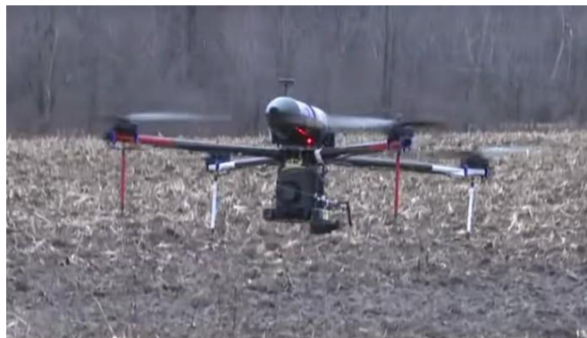
H2Quad 400 multi-rotoros, hidrogén tüzelőanyag-cellás drón, amely 2 órás repülési rekordot ért el. Kép: EnergyOr.
