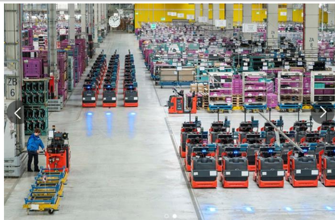
HTC anyagmozgató gépek és beltéri hidrogén tankolásuk a BMW lipcsei gyárában. Kép: www.now-gmbh.de
