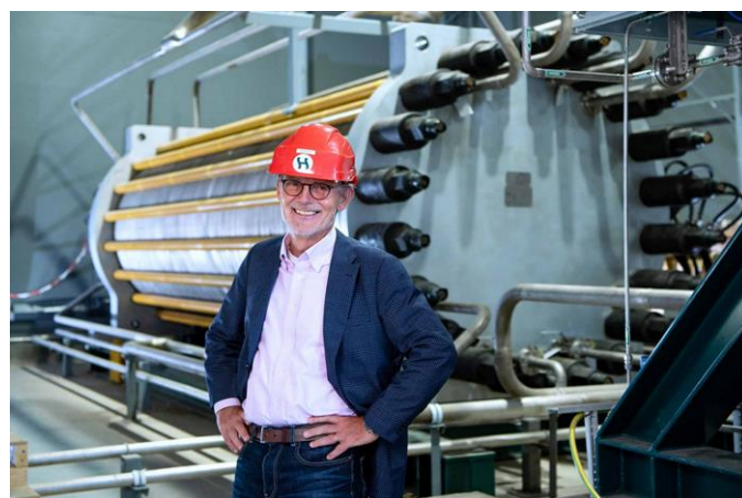
A HydrogenPro CEO-ja egy lúgos elektrolizáló előtt a cég gyártóüzemében. Kép: HydrogenPro.
