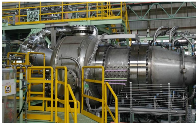
100% ammónia tüzelésre képes tesztmotor. Kép: H2-View.
