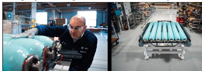
BMW Hydrogen Flat Storage System. Kép: BMW Group.
