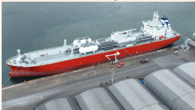
Ammónia port-to-ship bunkerolása Ulsanban.
