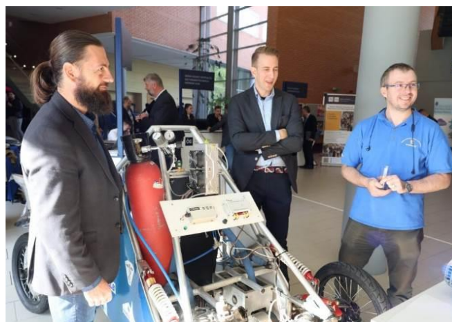
Kísérleti autómodell - hidrogén üzemű tüzelőanyagcellával.
