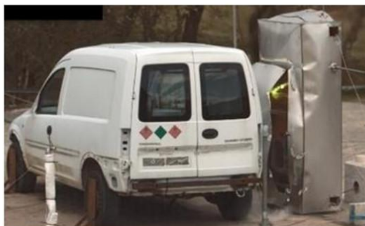
11. ábra: a projekt TT18 (b) és TT20 (j) tesztje: a diszpenzerben kialakuló gyúlékony gázfelhő robbanásának hatásai, ha a gyújtóforrás diszpenzeren belül (b) és azon kívül (j) jelenik meg. (Peremfetételek: 0,2 mm méretű hidrogénszivárgási pont, 700 bar nyomás) – a táblázatban a kialakuló túlnyomás értékek (mbar) láthatók különböző távolságban a H 2 -diszpenzertől.
