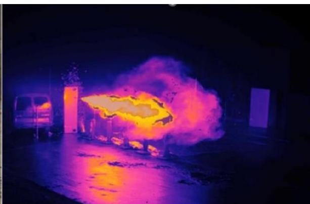
12. ábra: indukált jet fire tüzeset normál és IR-kamerás képe a kísérletek során
