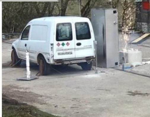
11. ábra: a projekt TT18 (b) és TT20 (j) tesztje: a diszpenzerben kialakuló gyúlékony gázfelhő robbanásának hatásai, ha a gyújtóforrás diszpenzeren belül (b) és azon kívül (j) jelenik meg. (Peremfetételek: 0,2 mm méretű hidrogénszivárgási pont, 700 bar nyomás) – a táblázatban a kialakuló túlnyomás értékek (mbar) láthatók különböző távolságban a H 2 -diszpenzertől.
