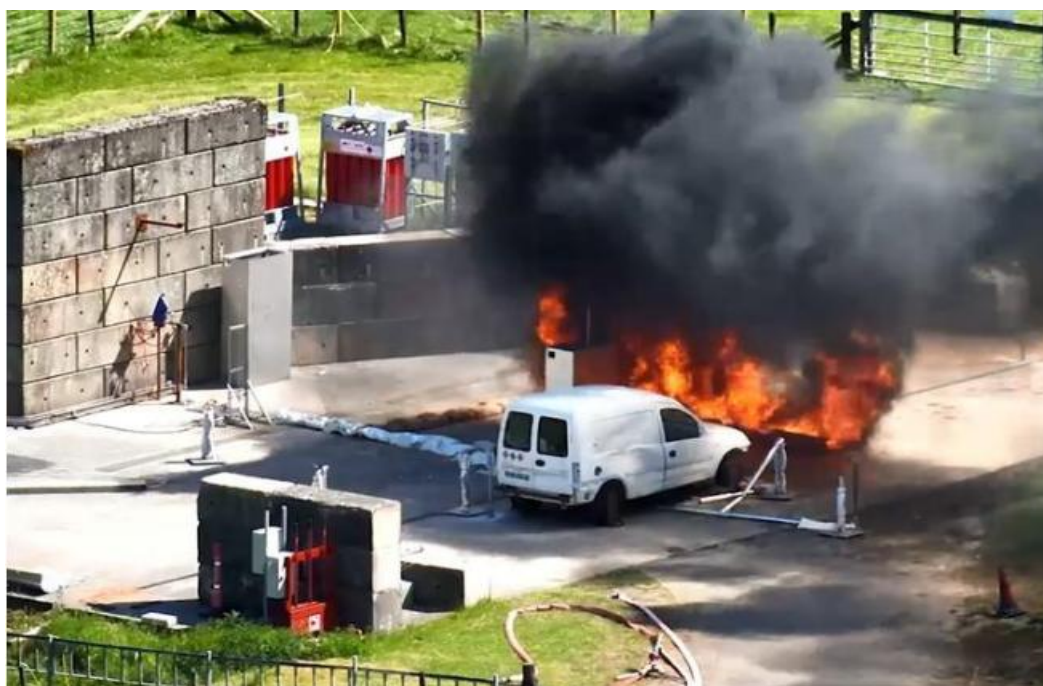
10. ábra: a projekt TT22-es tesztje, amelyben multi-üzemanyag töltőállomáson más, hagyományos üzemanyag (dízel) közeli tüzesetének hatásait vizsgálták a H_2 -diszpenzerre (peremfeltételek: 120 liter, 2\text{ m}^2 felületű dízel üzemanyag-kiömlés tócsatüze, 15 perces időtartamban a hidrogéndiszpenzer közvetlen közelében. A láng átmenetileg hozzáér a diszpenzerhez. Mindazonáltal a kísérleti diszpenzer belsejében a hőmérséklet alig változik. Ezenkívül a csővezetékben nem volt jele a belső nyomásnövekedésnek.
